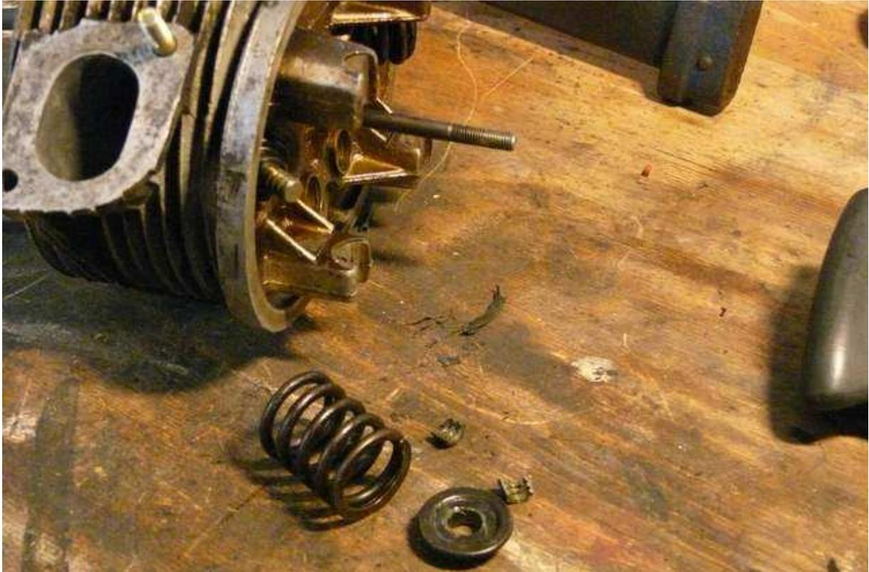
Alles wieder in die entsprechenden Kästchen packen, da Ein- und Auslas wohl verschiedene Federn haben. Jetzt sieht man die Ventilschaftdichtung, welche man, nachdem man das Ventil nach unten herausgezogen hat, mit einem kleinen Schraubendreher abhebeln kann.
