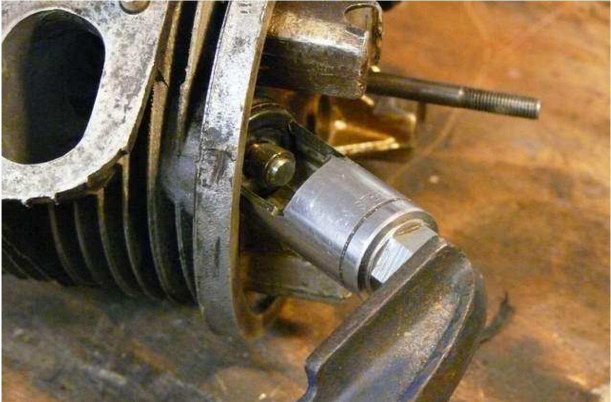
Wenn man die Schraubzwinde nun entspannt, dann kann man den Teller, die Feder und die Zentrierplatte abnehmen.
