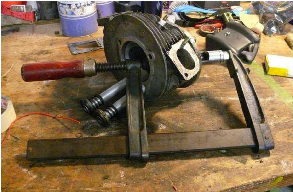
Dann sollte vorsichtig an dem Griff der Schraubzwinde drehen um den Federteller herunter zu drücken. Nun sieht man die Ventilkeile. Dies sind zwei Halbschalen welche zum Ventil hin konisch zulaufen. Mit einer kleinen Pinzette oder einem Schraubendreher kann man diese vom Ventilschaft lösen und sie fallen in die „Spezialnuss“.
