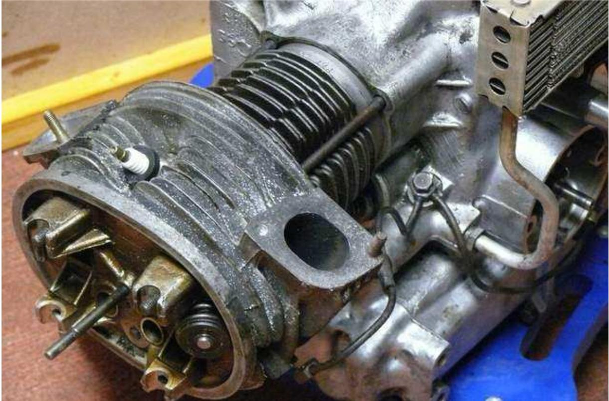
Das geht entweder mit einer Pinzette oder einem gefetteten Pinsel. Der Vorteil des vorher gefetteten Ventilschaftoberteiles, dort wo die Rillen sind, kommt jetzt nochmal zum Tragen. Die Keile haften und können verschoben werden, damit das Aufsetzen des anderen Keiles problemlos gelingt. Dann die Schraubzwinde entspannen und darauf achten, dass Keile nicht verrutschen. Schlussendlich einmal mit dem Hammer leicht auf den Ventilschaft klopfen, um zu testen ob die Keile richtig sitzen. Fertig.
